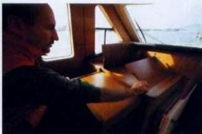
Il **copilota** e gli ospiti più "attenti" alle fasi di navigazione possono accomodarsi su un divanetto posto per baglio. Di fronte è stato ricavato il piano di carteggio scorrevole (necessita però di un fissaggio per evitare che in navigazione si apra autonomamente)
