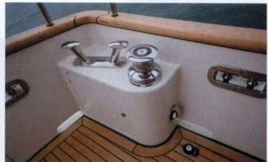
Sopra, i **winch** di tonneggio elettrici per le cime di ormeggio a poppa; una soluzione decisamente adeguata al peso e alle dimensioni dello Skagen 53. Belli anche i passacime in acciaio inox posizionati sia per l'ormeggio di poppa che per quello all'inglese
